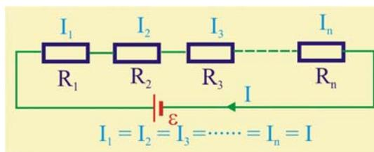
Рис. 2.5. Последовательное соединение сопротивлений
