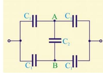
Рис. 194. Батарея конденсаторов
