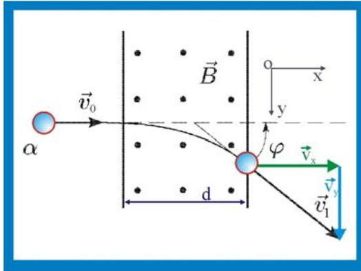
Рис. 36. Отклонение частицы
