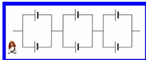
Рис. 84. Соединение источников
