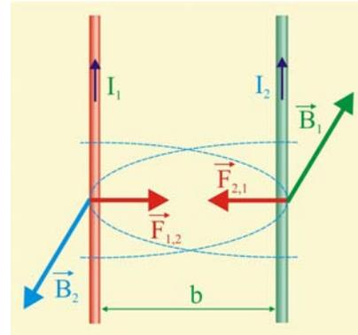
Рис. 3.14. Взаимодействие двух проводников с током
