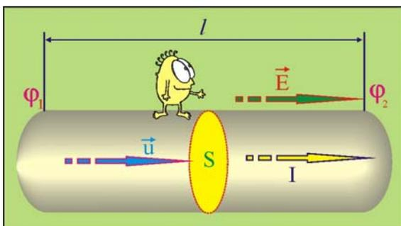
Рис. 2.3. Цилиндрический проводник с током
