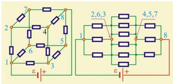
Рис. 2.9. Узлы равного потенциала
