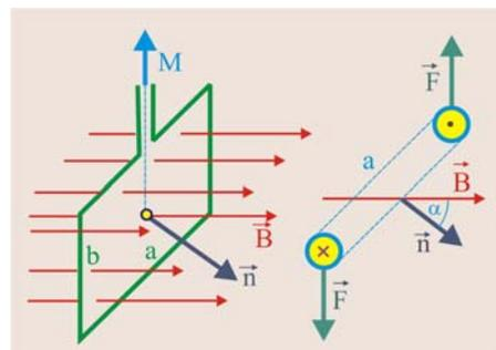
Рис. 1. Контур в магнитном поле
