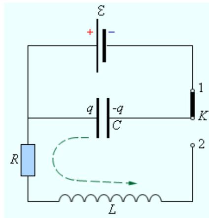
Рис. 4.12. Колебательный контур
