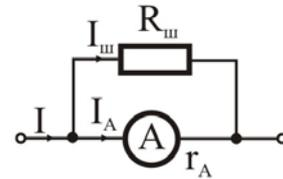
Рис. 58. Схема шунта
