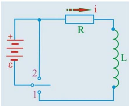
Рис. 4.6. Токи замыкания и размыкания
