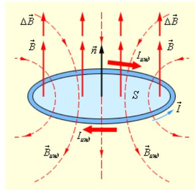
Рис. 4.3. Замкнутый контур в магнитном поле
