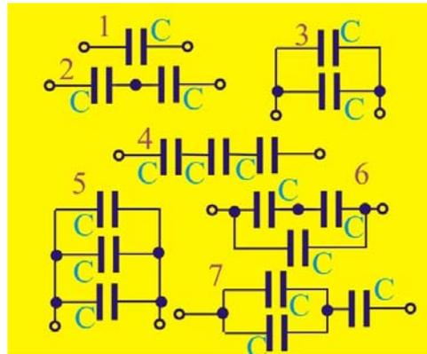
Рис. 186. Соединение трёх ёмкостей
