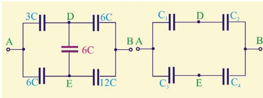
Рис. 196. Преобразование конденсаторной схемы
