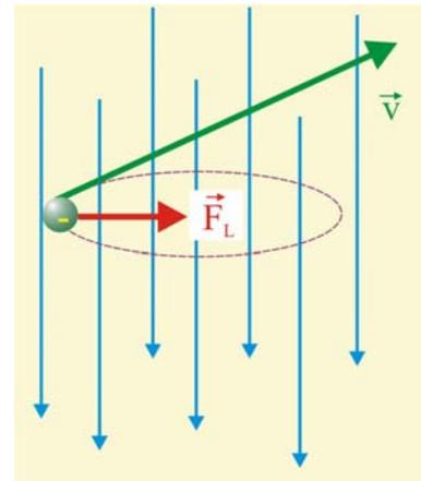
Рис. 3.6. Движение электрона в однородном магнитном поле
