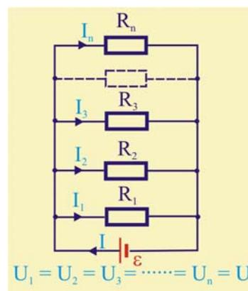
Рис. 2.6. Параллельное соединение сопротивлений
