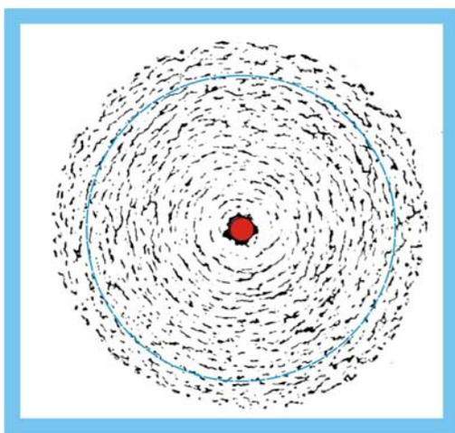
Рис. 3.2. Прямолинейный проводник с током
