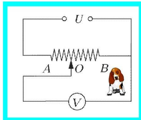
Рис. 52. Делитель напряжения
