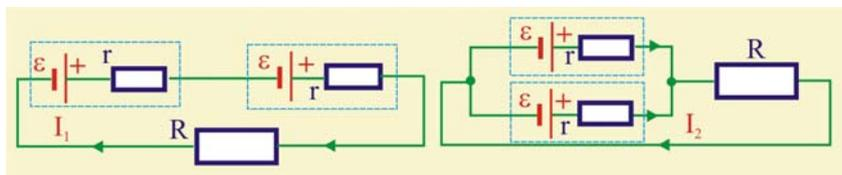
Рис. 5.25. Два способа включения источников тока
