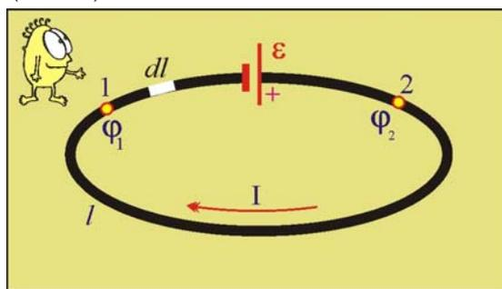
Рис.2.4. Замкнутая электрическая цепь
