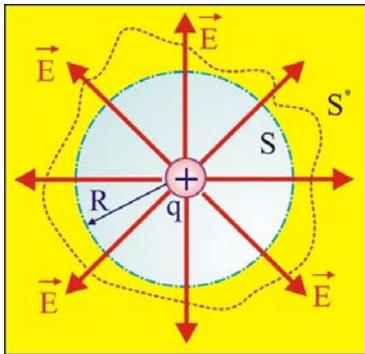
Рис. 1.9. Поток через произвольную поверхность
