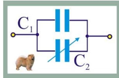
Рис. 172. Параллельное включение
