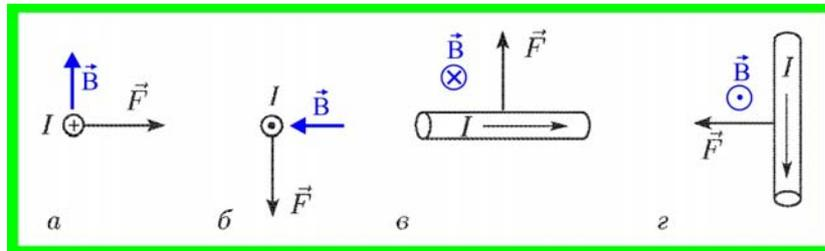
Рис. 7. Направление вектора магнитной индукции
