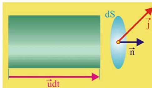
Рис. 2.2. Элементарный объём проводника
