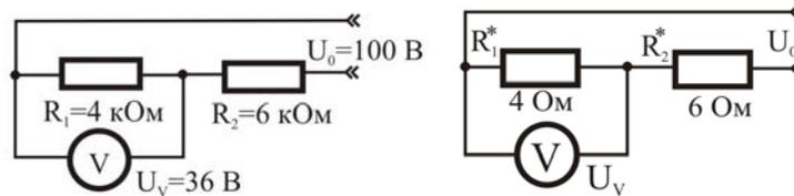
Рис. 59. Варианты включения вольтметра
