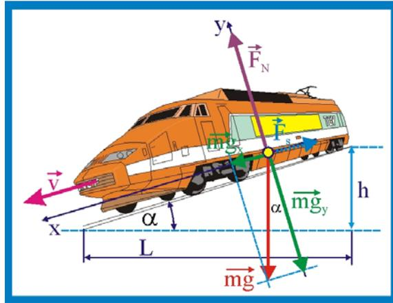
Рис. 147. Электровоз на спуске
