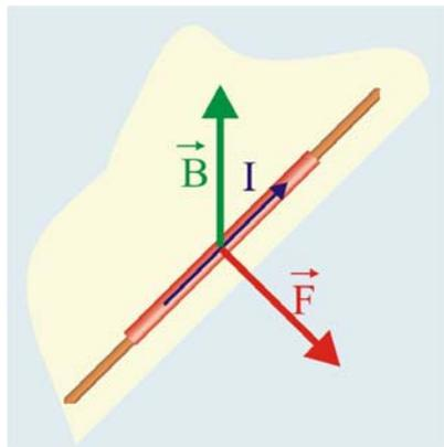
Рис. 3.13. Действие магнитного поля на проводник с током
