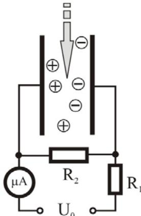
Рис. 64. Образование пар ионов
