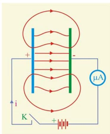
Рис. 4.13. Зарядка конденсатора
