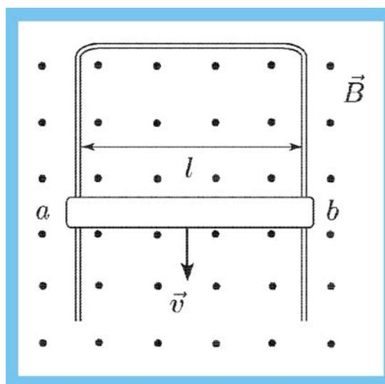
Рис. 55. Сопротивление перемычки
