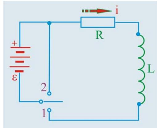
Рис. 72.3. Токи замыкания и размыкания
