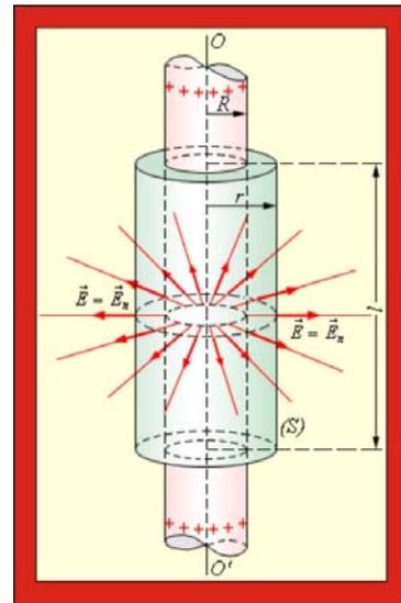
Рис. 1.10. Напряжённость поля заряженного цилиндра
