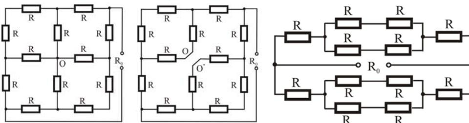
Рис. 56. Симметричная цепь и способ ее преобразования
