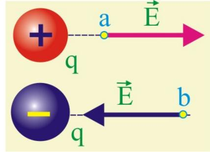
Рис. 1.3. Направление напряжённости электрического поля
