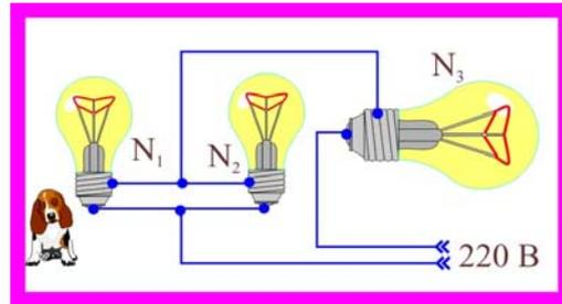
Рис. 123. Соединение ламп
