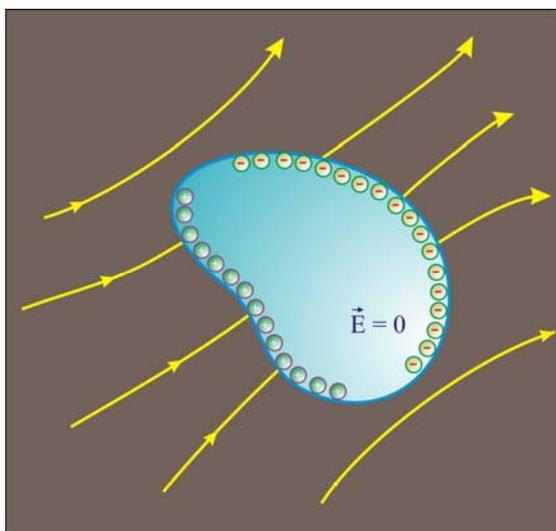
Рис. 1.16. Электризация проводника
