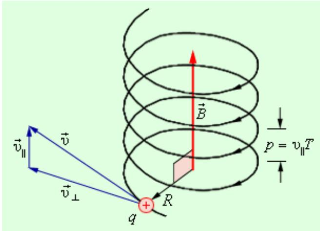
Рис. 33.2. Скорость частицы не перпендикулярна вектору магнитной индукции
