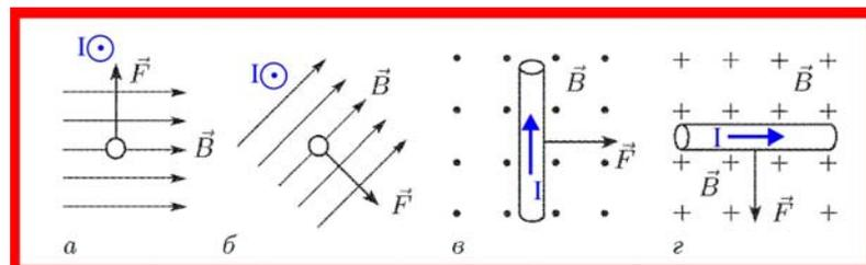
Рис. 8. Направление тока в проводниках
