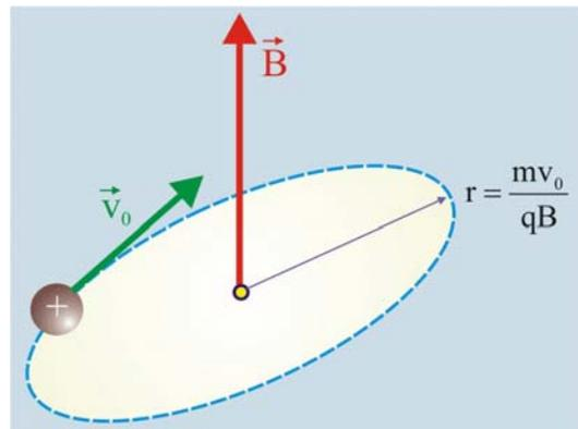
Рис. 33.1. Положительно заряженная частица в однородном магнитном поле
