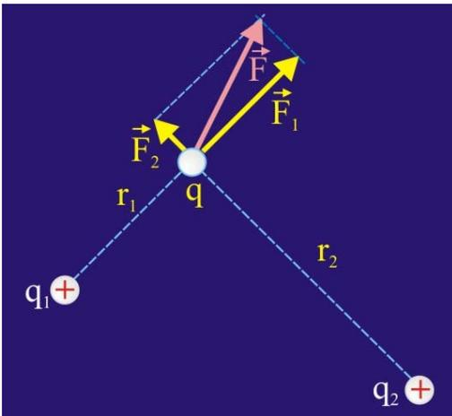
Рис. 1.2. Геометрическая сумма сил Кулона
