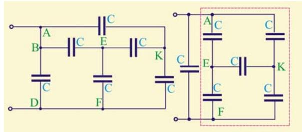
Рис. 194. Соединение одинаковых конденсаторов
