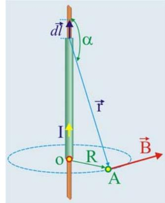
Рис. 3.9. Прямолинейный проводник с током
