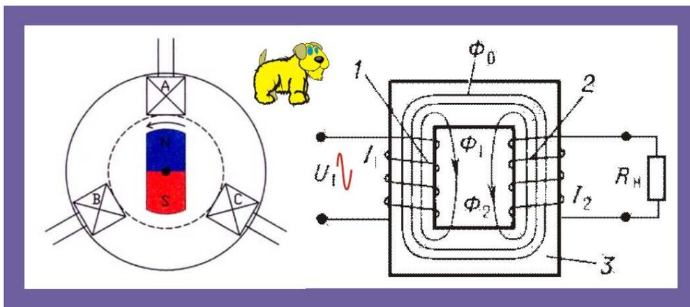
Рис. 4.7. Вращающийся магнит и трансформатор
