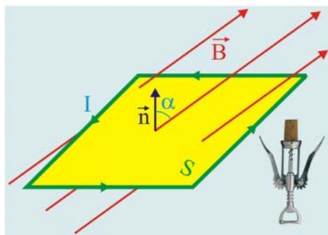
Рис. 3.11. Магнитный поток
