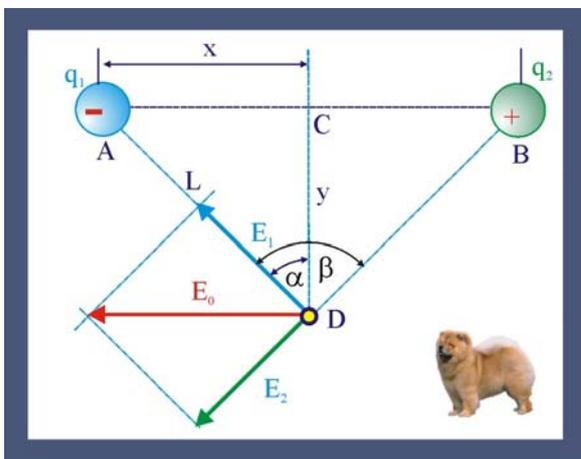
Рис. 61. Напряжённость поля диполя
