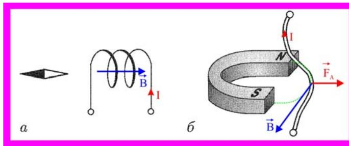
Рис. 9. Взаимодействия с магнитным полем
