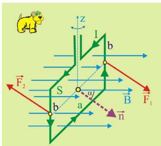
Рис. 3.17. Контур с током в магнитном поле
