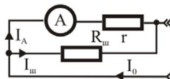
Рис. 62. Измерение тока
