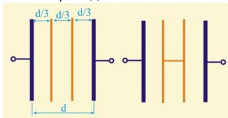
Рис. 191. Пластины в конденсаторе
