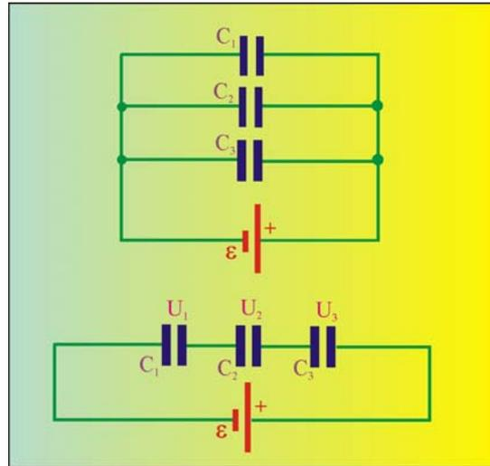
Рис. 1.17. Соединение конденсаторов
