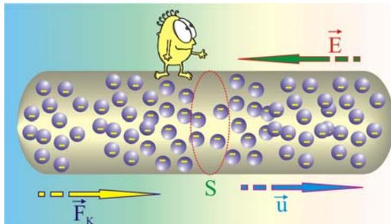
Рис. 2.1. Направленное движение носителей электрического заряда
