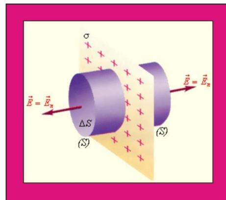
Рис. 1.11. Напряжённость равномерно заряженной плоскости
