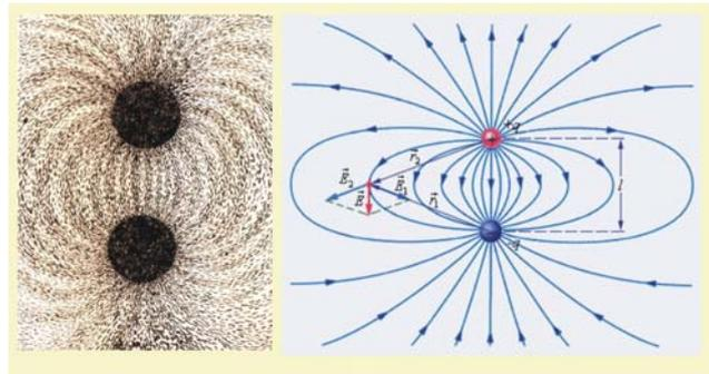
Рис. 1.6. Электрическое поле диполя
