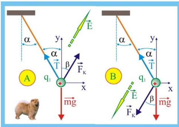
Рис. 73. Заряженный шарик в однородном поле
