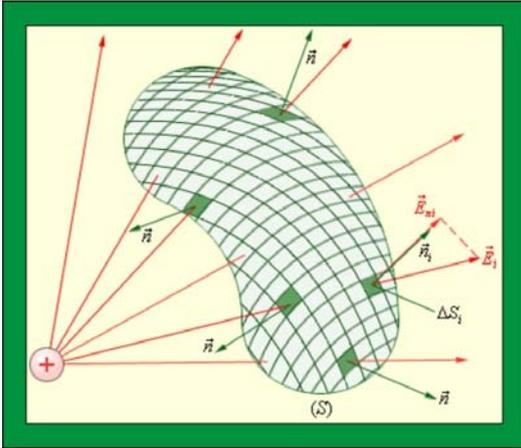
Рис. 1.8. Поток напряжённости через криволинейную поверхность
