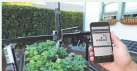
Роботизированная система, предназначенная для выращивания овощей. Управление данной системой осуществляется через Wi-Fi. Есть возможность удаленного контроля через Интернет.
